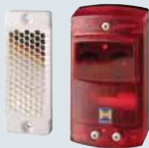
Световой барьер RL 50 Рефлекторный световой барьер с модулем приемник/передатчик и рефлектором. Система управления испытывает световой барьер перед каждым движением ворот вниз. Подсоединение с помощью системного провода (длина 2,0 м). Дальность действия: около 6,0 м Размеры: 68 x 97 x 33 мм (Ширина x высота x глубина) Рефлектор: 85 x 85 мм (Ш x В) Класс защиты: IP 65
