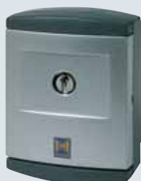
Замок STAP с 2-мя ключами исполнение для наружной проводки Функция импульс или откр/закр на выбор Размеры: 80 x 110 x 68 мм (Ширина x высота x глубина) Класс защиты: IP 54
