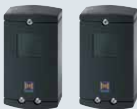
Световой барьер EL 51 Односторонний световой барьер с отдельными приемником и передатчиком. Система управления испытывает световой барьер перед каждым движением ворот вниз. Подсоединение с помощью системного провода (длина определяется размерами ворот). Дальность действия: около 8,0 м Размеры с монтажным кронштейном: 60 x 165 x 43 мм (Ширина x высота x глубина) Класс защиты: IP 65
