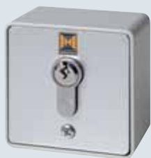
Замок ESA 30 с 2-мя ключами исполнение для наружной проводки Функция импульс или откр/закр на выбор Размеры: 73 x 73 x 50 мм (Ширина x высота x глубина) Класс защиты: IP 54
