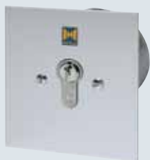
Замок ESU 30 с 2-мя ключами исполнение для скрытой проводки Функция импульс или откр/закр на выбор Размеры розетки: 60 x 58 мм (Д x Г) Размеры лицевой панели: 90 x 100 мм (Ш x В) Отверстие в стене: 65 x 60 мм (Д x Г) Класс защиты: IP 54
