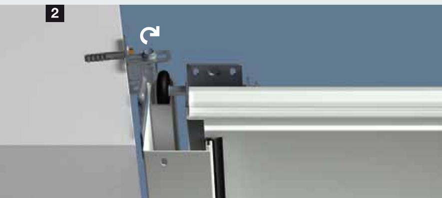
**1** Монтаж при расстоянии до стены макс. 35 мм
