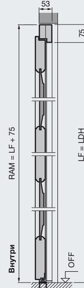
Боковая дверь из массивной древесины
