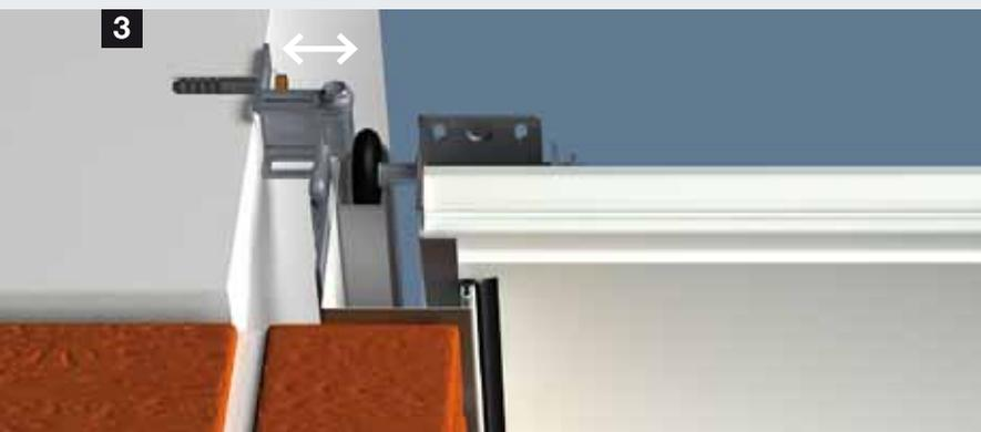
**3** Монтаж на ненесущую стену (облицовочный кирпич или теплоизоляция) с мин. 90 мм / макс. 125 мм бокового упора
